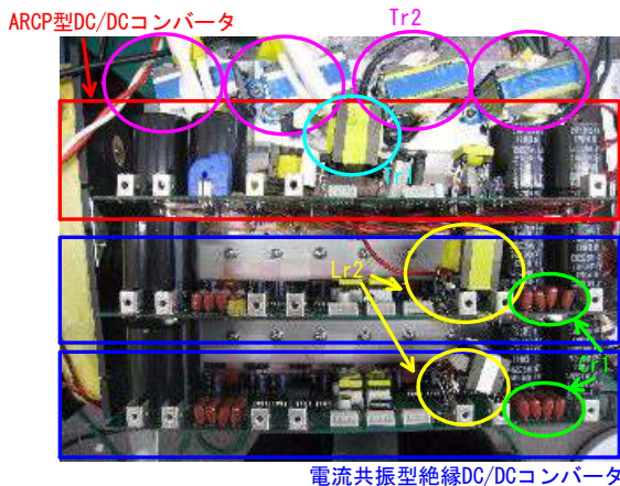
図 9 主回路構造
